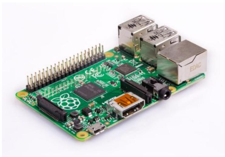
Abb. 3.12: Ein Raspberry Pi 2 übernimmt die Ansteuerung der Schrittmotoren und der Counter ICs (Quelle: (16)) .
