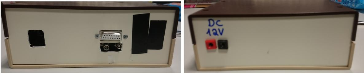
(a) Frontansicht des Gehäuses: links Ethernetanschluss des Raspberry Pis. Mitte: LEMO Buchsen als Signaleingang
