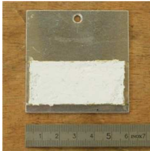
Abbildung 3.3: BaSO_4 Fluoreszenztarget auf Aluminiumträger.
