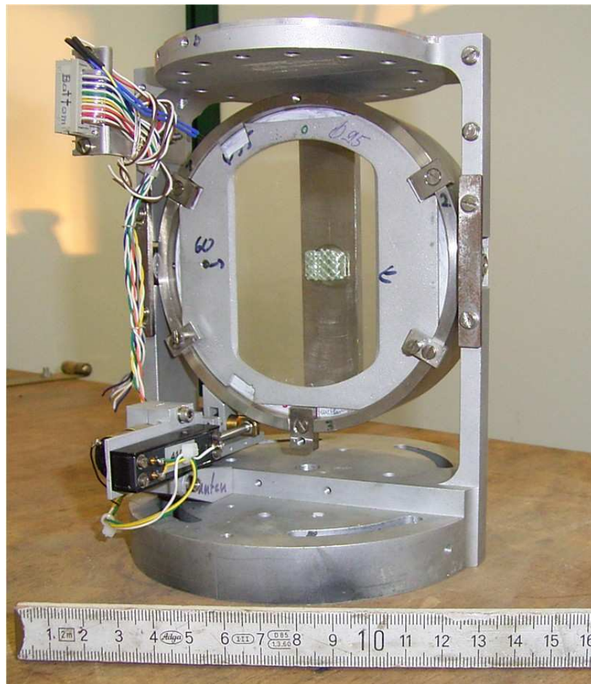
Abbildung 3.7: Kristallhalter mit Kristall und Apertur der Weite 60 mm. Links unten ist der Stellmotor mit Linearpotentiometer für die Spiegelkipfung (Tilt) zu sehen.
