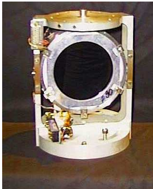
Abbildung 3.13: Einer der verwendeten Kristalle eingebaut in seinem Halter. Der Motor links oben dient zur Variation des vertikalen Kippwinkels. Zur Einstellung von \vartheta_B wird der Halter samt Kristall im Kristalltopf gedreht.
