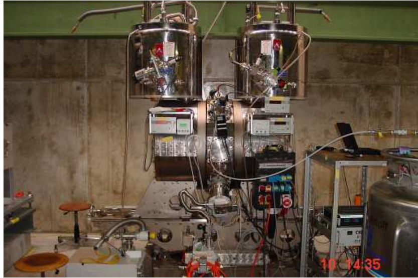
Abbildung 3.3: Die Zyklo- tronfalle beim Aufbau des Experiments. Sichtbar sind die zwei He-Dewars für die su- praleitenden Magnete.
