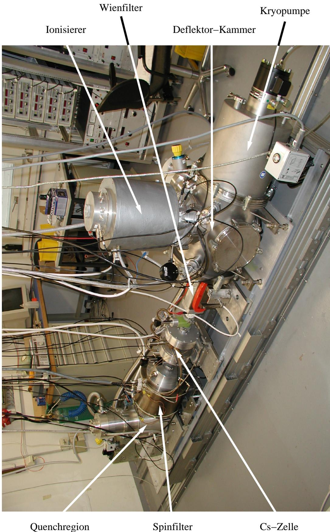
**Abbildung 4.2:** Das Lambshift-Polarimeter und seine Komponenten.
