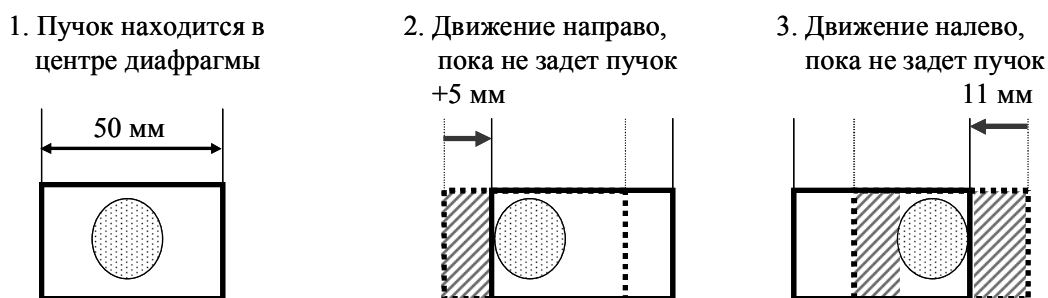
Рис. 16. Принцип измерения профиля пучка COSY
